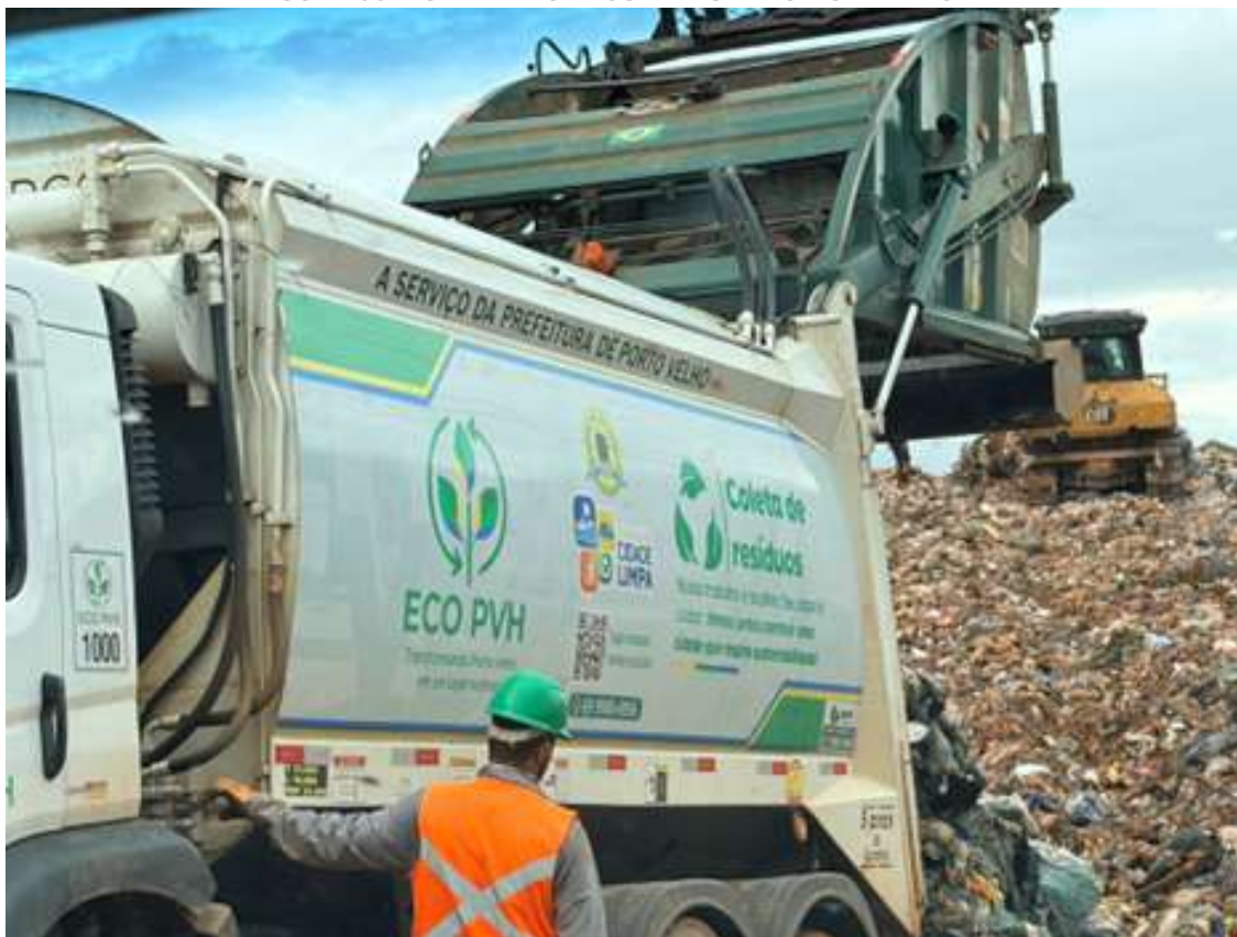
FIGURA 65 – CAMINHÃO DESCARREGANDO NO ATERRO
