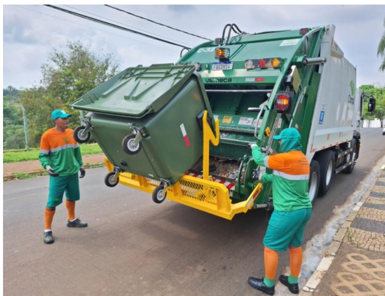
FIGURA 4 – COLETA MECANIZADA – CONTÊINER
